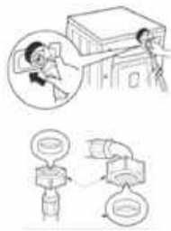
Соединитель для подачи воды с резиновым уплотнителем
