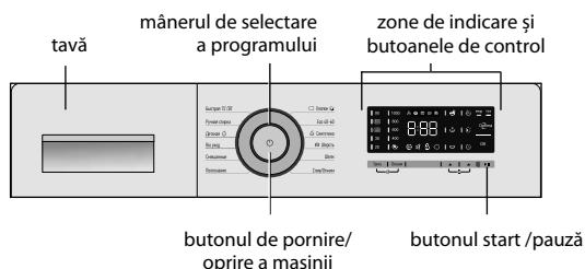
Figura 1 – Panoul de control
