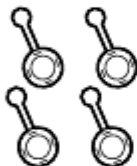
Заглушки для закрытия отверстий для переходных болтов
